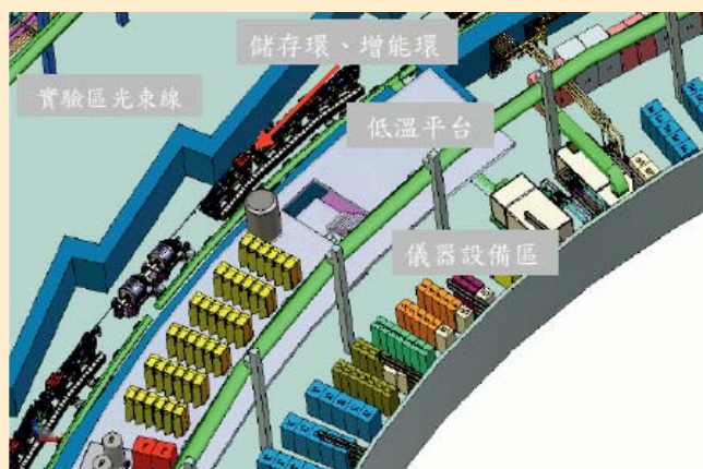
圖二 加速器環館局部放大圖。鋸齒狀左側外牆為光束線與實驗區，右側內牆依序分制為儲存環及增能環。圓形屏蔽牆右側則為加速器儀器設備區。
